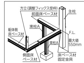
床ベース材は床施工の際に便利な本体基礎部材。ジーマ本体を床ベース材の上に施工後、土間モルタルを充填、またはデッキ取付けできます。
