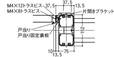
※サブ門柱の寸法は、木粉入り樹脂サブ門柱の寸法を示す。
