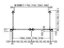
※本図は標準門柱90度開時を示します。 陸屋根付門柱・デラックス門柱納まりも有効開口寸法は同じです。
