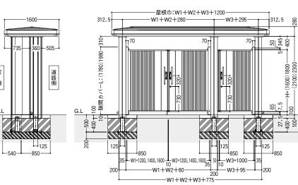
●中門柱側面図 ●中門柱内観図 (機能側)
