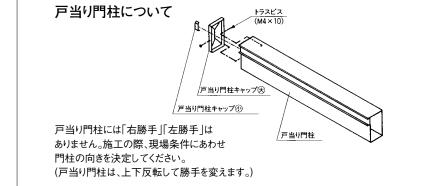
●取付けは、梱包内の取付説明書に従って、正常な組立・施工をしてください。 ●照明など市販品取付けの時も同様にしてください。結線BOXまでの電線管 埋設配管など電気工事店様とお打ち合わせの上、工事にかかってください。
